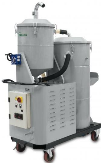
Le A 207 OIL-P est un aspirateur industriel triphasé adapté au travail en continu et intensif, idéal pour l'aspiration des huiles et boues. Doté d'une turbine triphasée à canal latéral avec carter de protection, cet appareil est particulièrement compact avec une capacité de cuve pour liquides de 200litres. Cette version permet de vidanger les liquides pendant l'aspiration.
